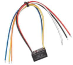
Todos los ventiladores incluyen un relay contra incendio de bajo voltaje que puede ser cableado al sistema de supresión contra incendio del edificio para apagar el ventilador automáticamente cuando los aspersores de agua son activados.
